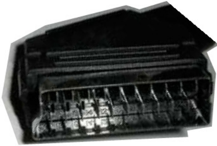
Scart: 21-poliger Euro-AV-Anschluss
